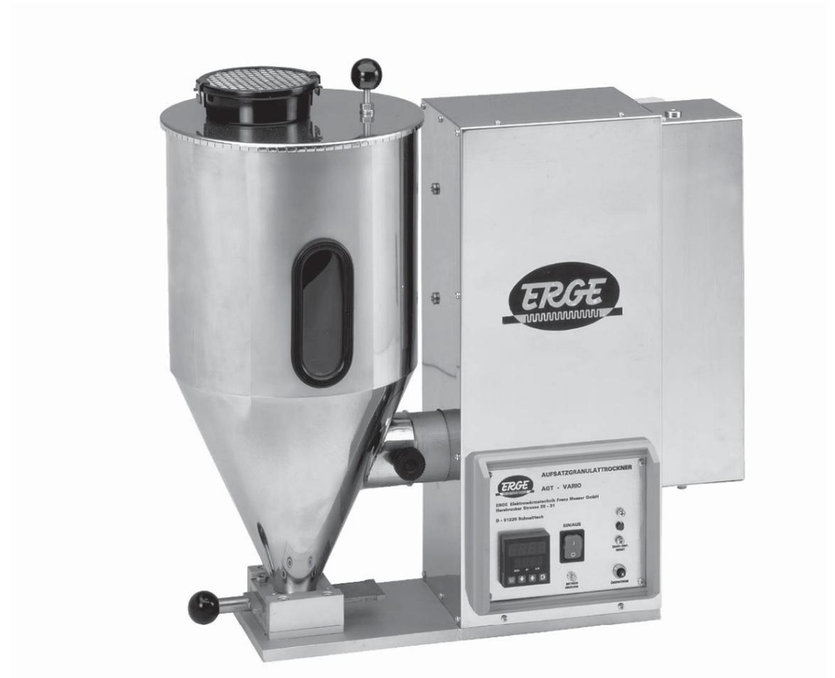
Der Einsatz von Granulattrocknern in der Fertigung wird immer notwendiger. Bei der Herstellung von durchsichtigen Werkstücken oder kleinen Präzisionsteilen ist eine Vortrocknung meist unumgänglich.
